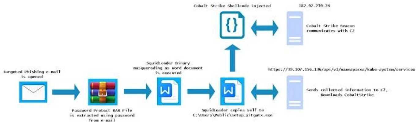
SquidLoader representa una amenaza considerable debido a su amplia gama de técnicas anti-análisis, anti-sandbox y anti-debug, lo que le permite evadir la detección y dificultar su análisis. Además, puede establecer comunicación con un servidor remoto para enviar información del sistema infectado e inyectar la siguiente carga maliciosa.
