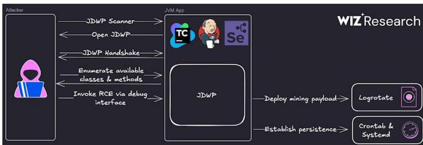
En los ataques monitoreados por Wiz, los actores maliciosos explotan el hecho de que la Máquina Virtual de Java (JVM) escucha conexiones del depurador en el puerto 5005, lo que les permite escanear la red en busca de puertos JDWP abiertos. En la siguiente etapa, se envía una solicitud JDWP-Handshake para verificar si la interfaz está activa y así establecer una sesión.
